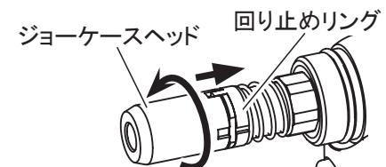
3 回り止めリングを図の方向へ引き、ジョーケースヘッドを緩めて外します。
